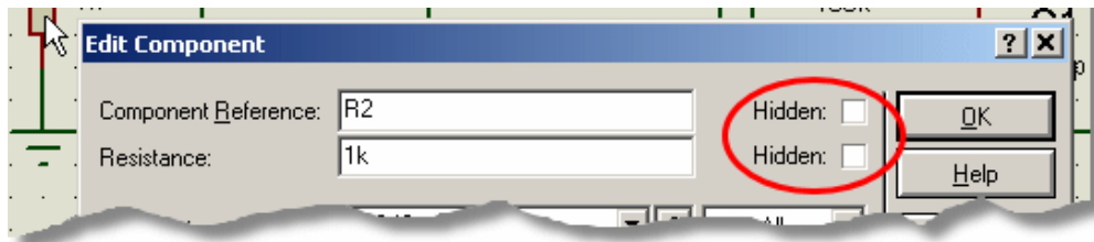
Edit Component ダイアログにおける、コンポーネント・リファレンスと抵抗値の表示。
